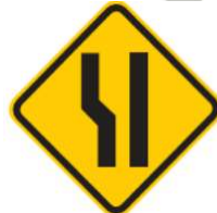
A-21d ALARGAMENTO DE PISTA À ESQUERDA
