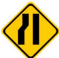
A-21b ESTREITAMENTO DE PISTA À ESQUERDA
